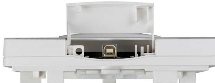
Sicht von vorne mit offenem Zugang zu drahtgebundenen Schnittstellen
